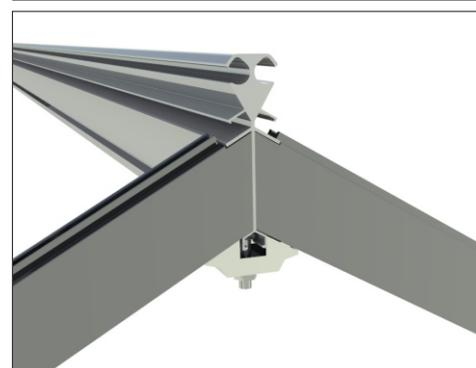
**Шаг 12** Установить, через одинаковое расстояние (590 мм между краями профилей) крышные шпросы **АТП100**, **АТП103Л**, **АТП103П** и на расстоянии (420 мм между краями профилей) крышные шпросы **АТП104**, соединив их с боковым коньком и боковой стойкой **АТП001**, а также между собой и крышным коньком, при помощи «сухаря» **ТК001**, «специального винта» **ТК200** и гаек **ТК202**.
