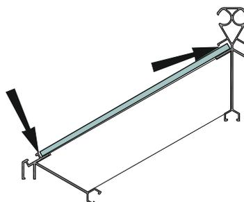
**Шаг 3** Как только установлено рядом два заполнения, на крышной направляющей по всей длине устанавливается резиновый уплотнитель (👉).
