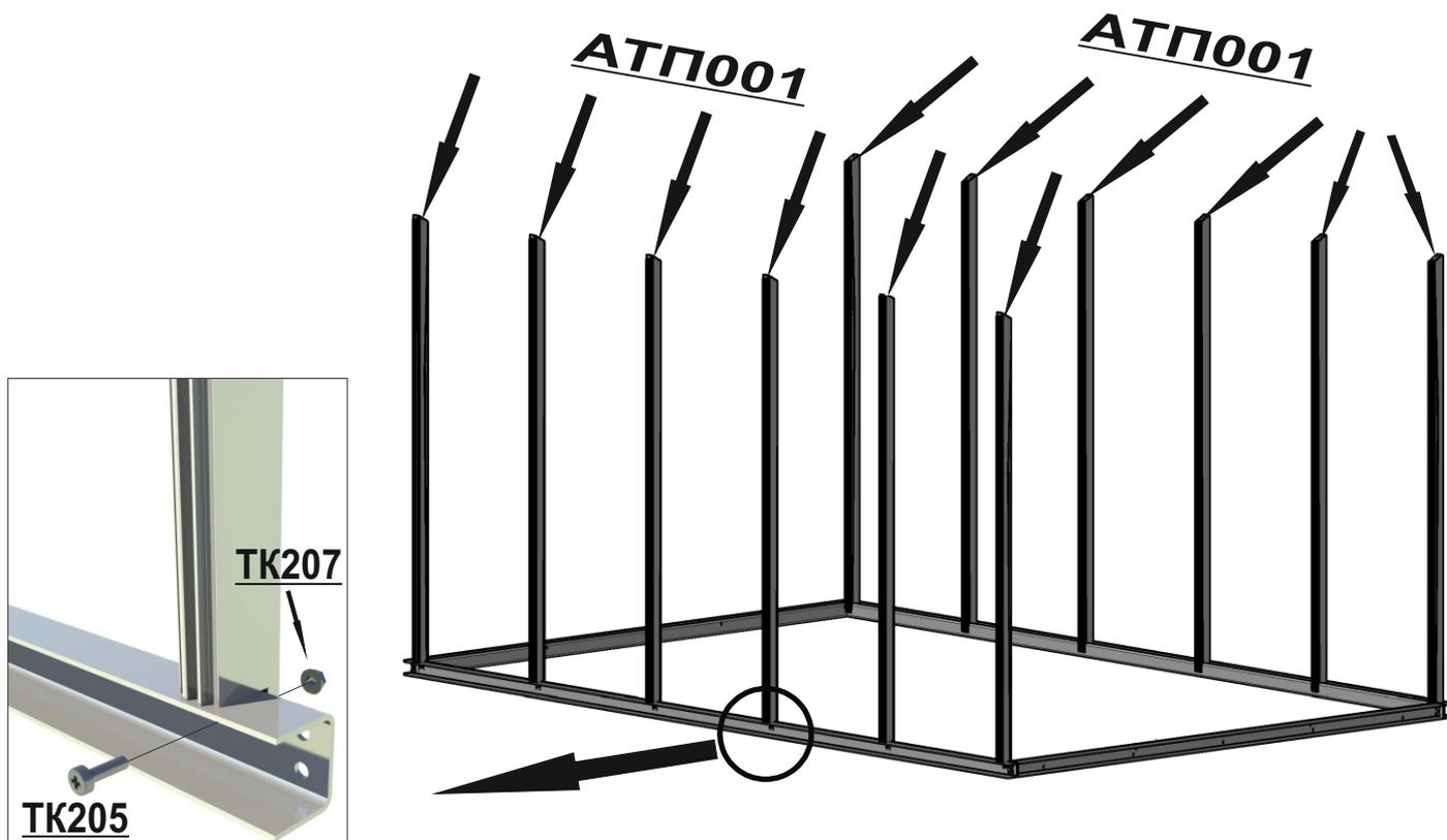
**Шаг 5** Установить на основание стойки переднего и заднего торца теплицы АТП003min – АТП006min и закрепить их при помощи винтов ТК205 и гаек с фланцем ТК207.
