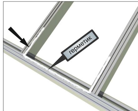
**Шаг 2** На направляющие укладывается заполнение и аккуратно сдвигается вверх, пока верхняя кромка заполнения не зайдет до упора в паз верхнего конька, а нижняя кромка не встанет в паз H-профиля (планка делитель стекла).
