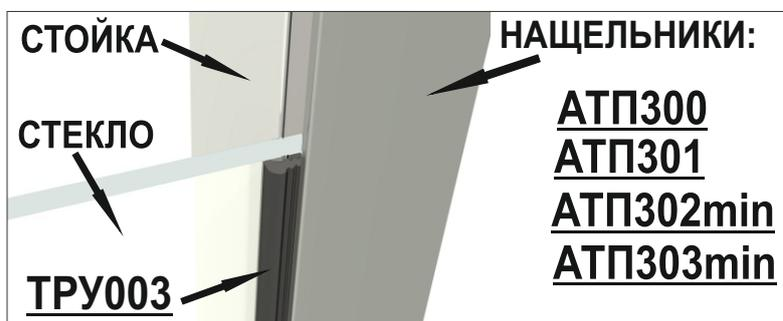
При установке торцевого заполнения необходимо использовать соединительные планки (н-профиль) между заполнением.
