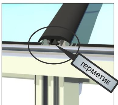
**Внимание:** в местах установки фарточки у резинового уплотнителя со стороны установки фарточки удалить один «ус» при помощи ножа.
