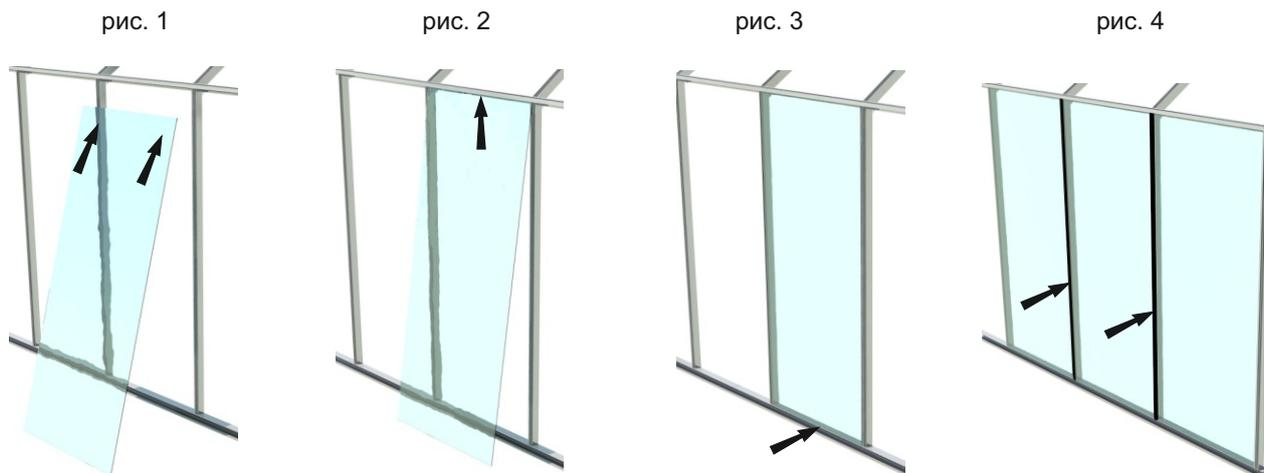
**Шаг 3** После установки двух листов стекло (поликарбоната) рядом друг с другом следует проложить резиновый уплотнитель (👁) на стойку между ними (рис. 4).
