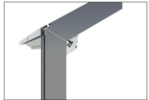
**Шаг 9** Вставить крышный конек АТП200 в шпросы крыши АТП101min и АТП102min и соединить вместе при помощи «сухаря» ТК001, «специального болта» ТК200 и гаек ТК202.
