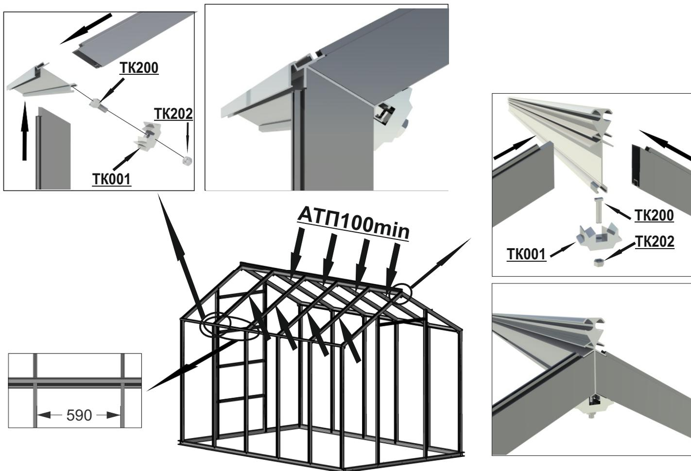
**Шаг 11** Собрать крышные растяжки **АТП500min** и подвесы **АТП501min** при помощи винтов **ТК203** и гаек **ТК202**. Установить их на крышные шпросы **АТП100min** при помощи винтов **ТК205** и гаек **ТК202**.
