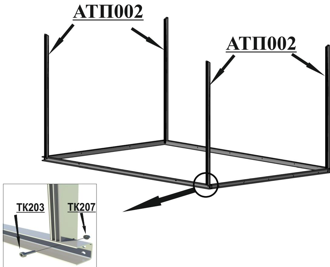
**Шаг 3** Установить на основания следующие стойки теплицы боковые **АТП001** и закрепить их при помощи винтов **ТК205** и гаек с фланцем **ТК207**.
