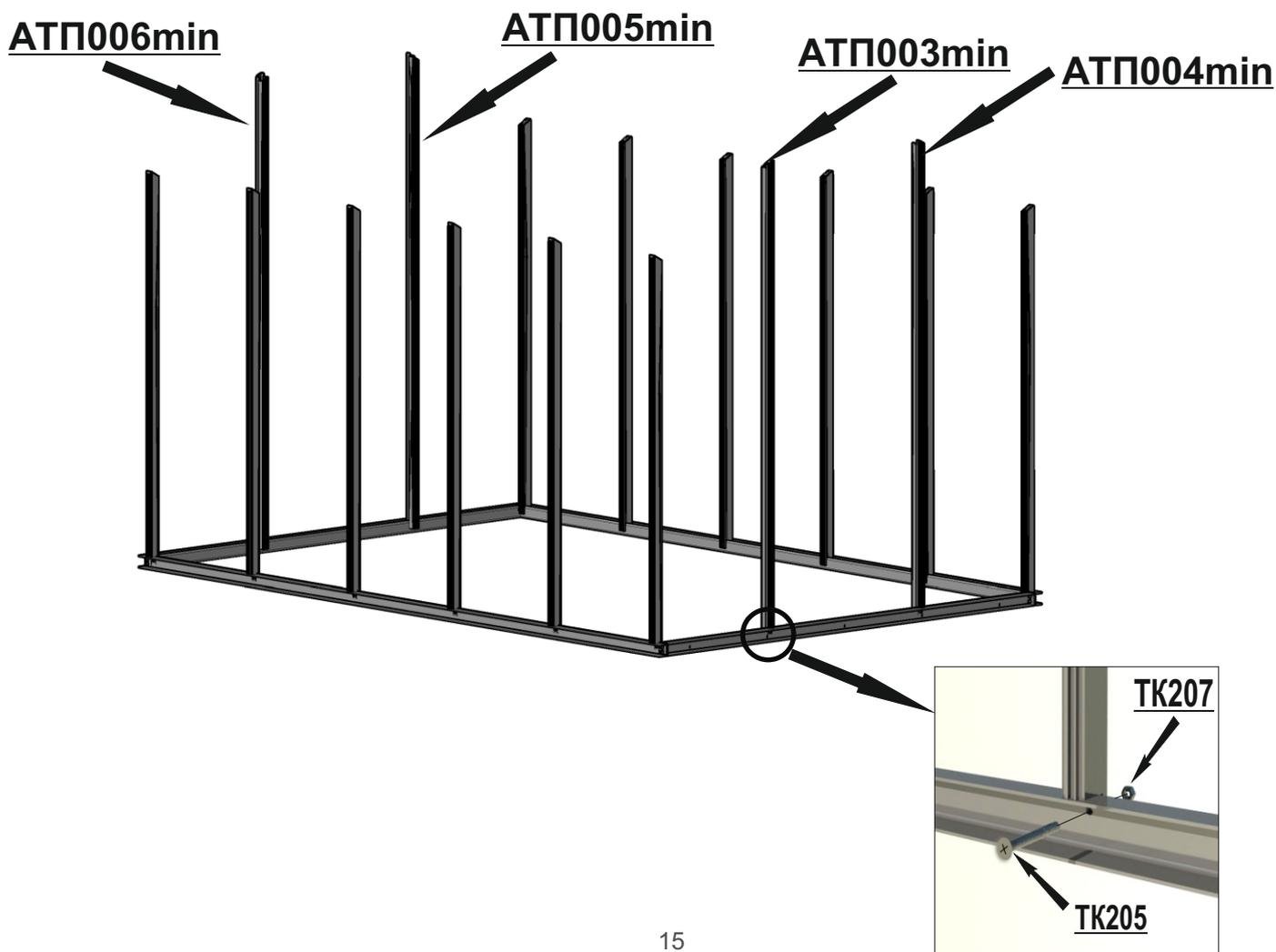
**Шаг 6** Установить на торцевые стойки теплицы АТП003min, АТП004min и АТП005min, АТП006min ригеля АТП400, при помощи соединительных элементов ТК101 и винтов ТК203.
