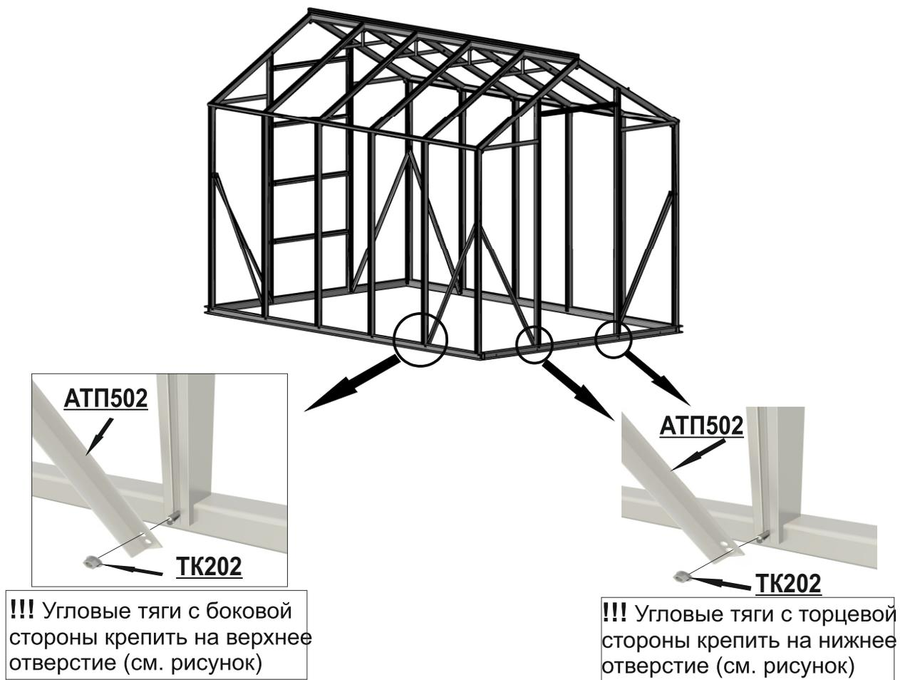
**Шаг 10** Установить, через одинаковое расстояние (590 мм между краями профилей) крышные шпросы **АТП100min**, соединив их с боковым коньком и боковой стойкой **АТП001**, а также между собой и крышным коньком, при помощи «сухаря» **ТК001**, «специального винта» **ТК200** и гаек **ТК202**.
