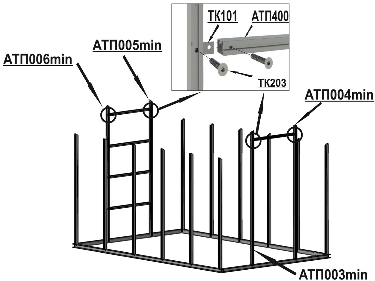
**Шаг 7** Установить на торцевые стойки теплицы АТП003min - АТП006min торцевые крышные шпресы АТП101min и АТП102min, соединить их при помощи элементов ТК100 и винтов ТК203.
