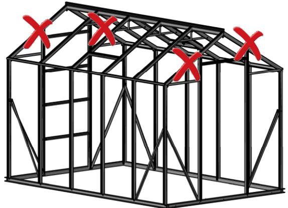
**Шаг 1** На профиль крышных направляющих, а также профиль бокового конька в местах соприкосновения стекла и алюминиевого каркаса нанести слой герметика.
