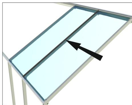
**Шаг 4** в месте стыка бокового конька и паза для резины необходимо нанести толстый слой герметика для заделки соединения. После того установить в паз резиновый уплотнитель (👉).
