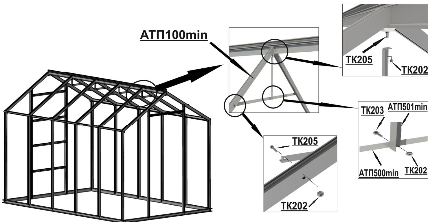
**Шаг 14** Установить ригеля под форточки **АТП401** на расстоянии 362мм от края бокового конька, при помощи соединительной планки **ТК003**, «специального» малого болта **ТК201** (заводится в паз ригеля **АТП401**) и гайк **ТК202**.
