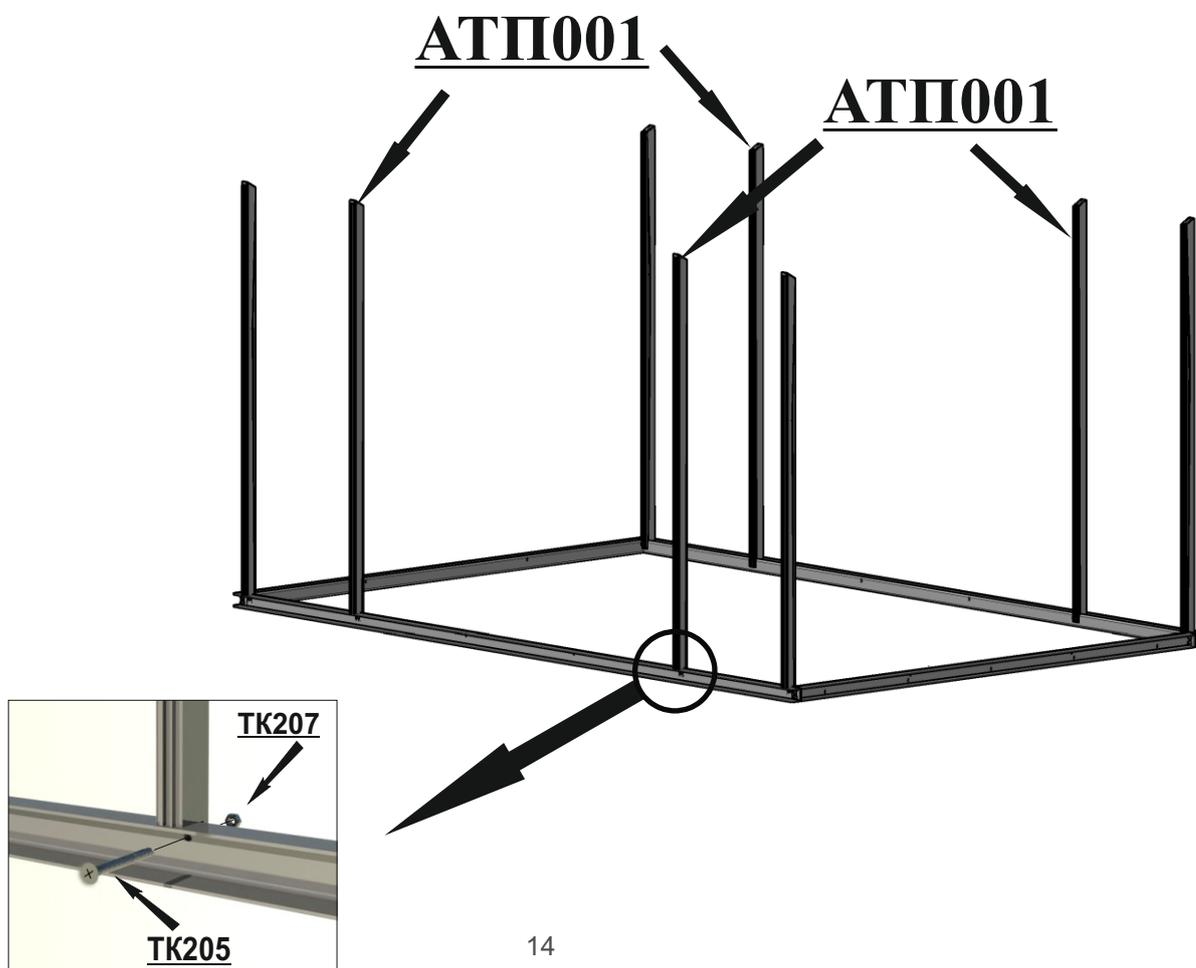
**Шаг 4** Установить на основание стойки теплицы боковые АТП001 и закрепить их при помощи винтов ТК203 и гаек с фланцем ТК207.
