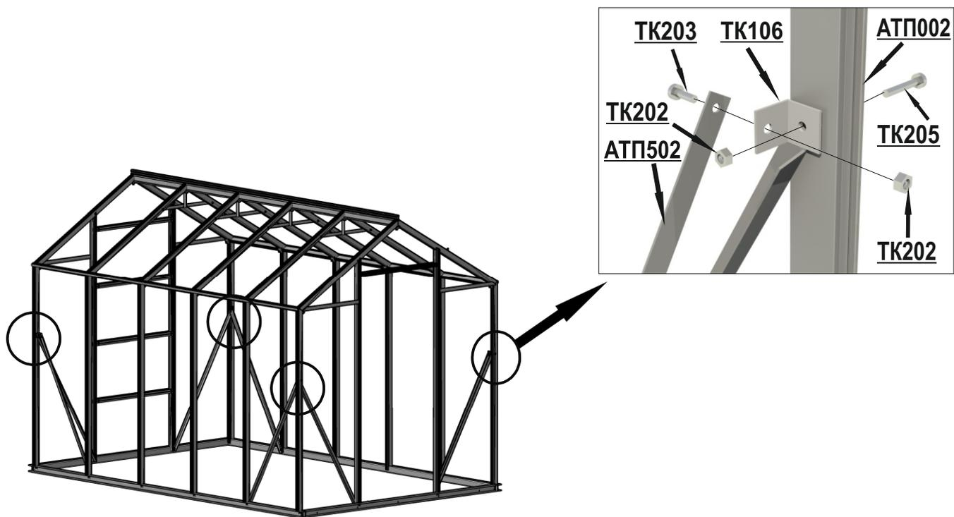
**Шаг 13** Прикрепить угловые тяги к узлу соединения стойки и основания при помощи гаек **TK202**, как показано на рисунке.
