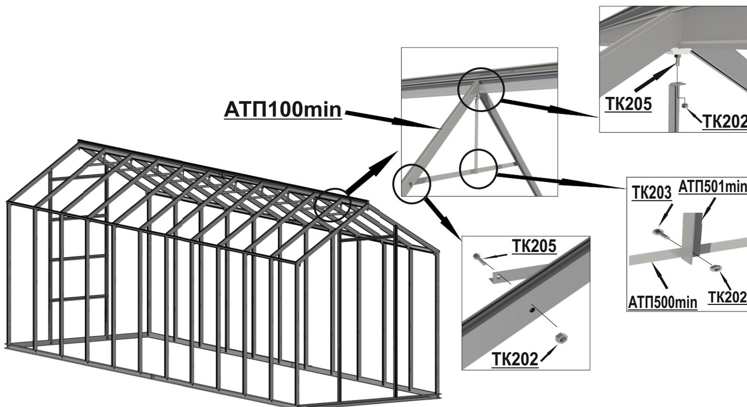
**Шаг 12** Установить угловые растяжки, используя для крепления кронштейн **TK106** как показано на рисунке.
