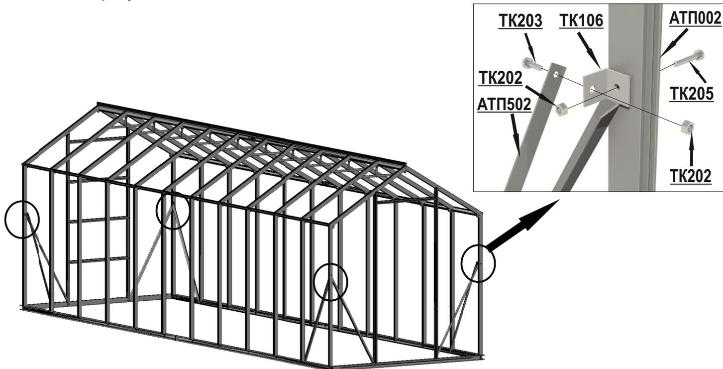
**Шаг 13** Прикрепить угловые тяги к узлу соединения стойки и основания при помощи гаек **TK202**, как показано на рисунке.
