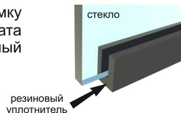
**Шаг 2** Заполнение устанавливается следующим образом: поднести заполнение и приложить верхней кромкой к боковым направляющим стойкам (рис. 1), далее по направляющим заполнение поднять вверх пока не зайдет до упора в паз бокового конька (рис. 2), далее заполнение снизу необходимо прижать к направляющим стойкам (рис. 3)
