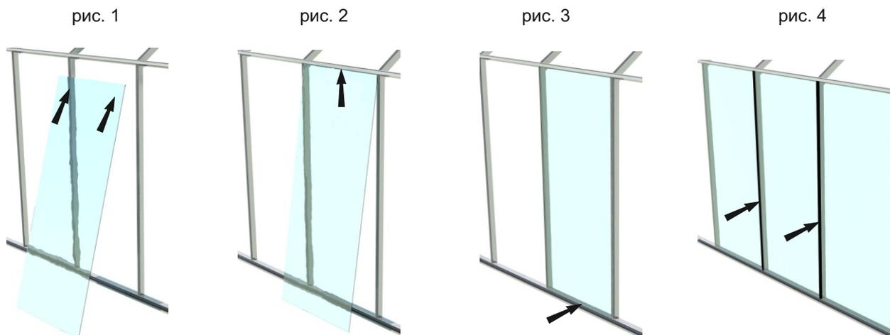
**Шаг 3** После установки двух листов стекол (поликарбоната) рядом друг с другом следует проложить резиновый уплотнитель (👁) на стойку между ними (рис. 4).
