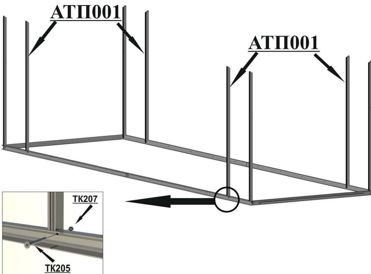
**Шаг 4** Установить на основание стойки теплицы боковые АТП001 и закрепить их при помощи винтов ТК203 и гаек с фланцем ТК207.
