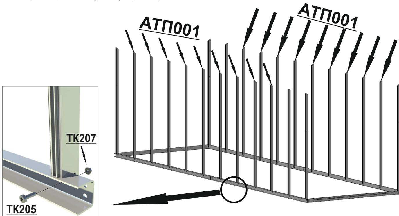
**Шаг 5** Установить на основание стойки переднего и заднего торца теплицы АТП003min – АТП006min и закрепить их при помощи винтов ТК205 и гаек с фланцем ТК207.
