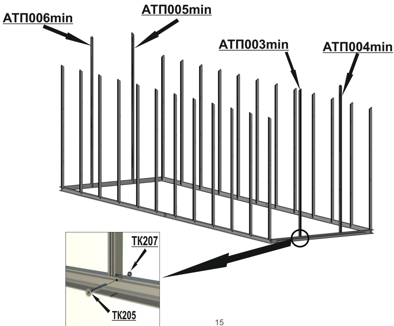
**Шаг 6** Установить на торцевые стойки теплицы АТП003min, АТП004min и АТП005min, АТП006min ригеля АТП400, при помощи соединительных элементов ТК101 и винтов ТК203.
