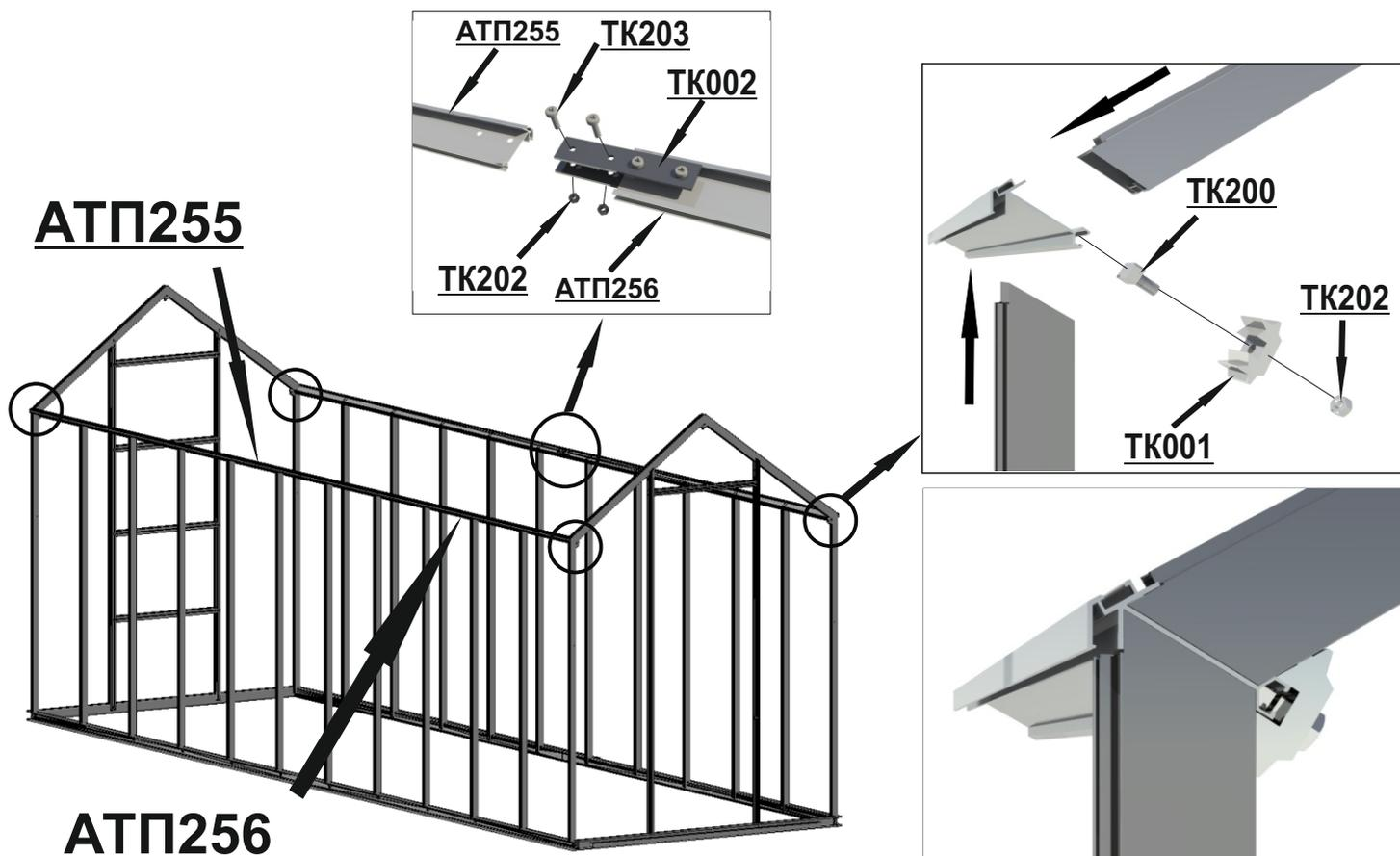
**Шаг 9** Вставить собранный крышный конек в шпрсы крыши АТП101min и АТП102min и соединить вместе при помощи «сухаря» ТК001, «специального болта» ТК200 и гаек ТК202.
