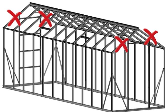
**Шаг 1** На профиль крышных направляющих, а также профиль бокового конька в местах соприкосновения стекла и алюминиевого каркаса нанести слой герметика.
