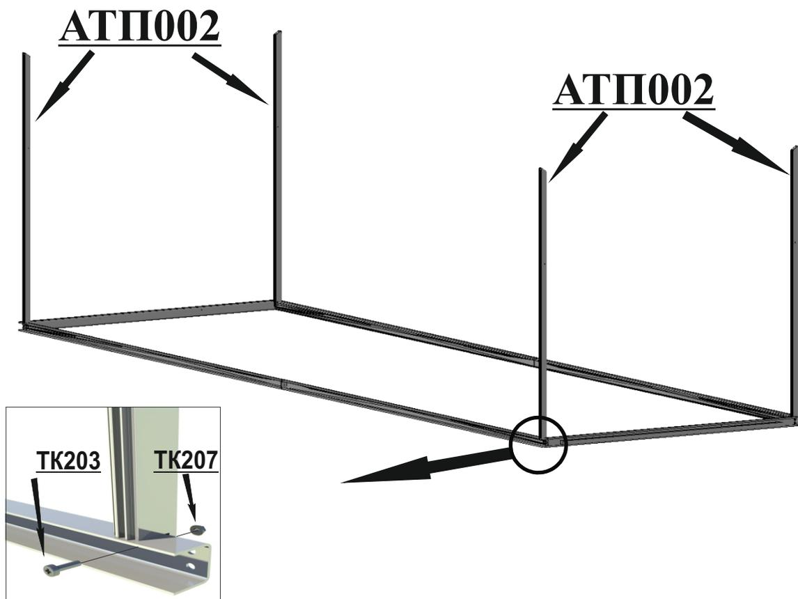
**Шаг 3** Установить на основание следующие стойки теплицы боковые **АТП001** и закрепить их при помощи винтов **ТК205** и гаек с фланцем **ТК207**.
