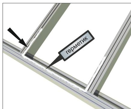
**Шаг 2** На направляющие укладывается заполнение и аккуратно сдвигается вверх, пока верхняя кромка заполнения не зайдет до упора в паз крышного конька, а нижняя кромка не встанет в упор бокового конька.
