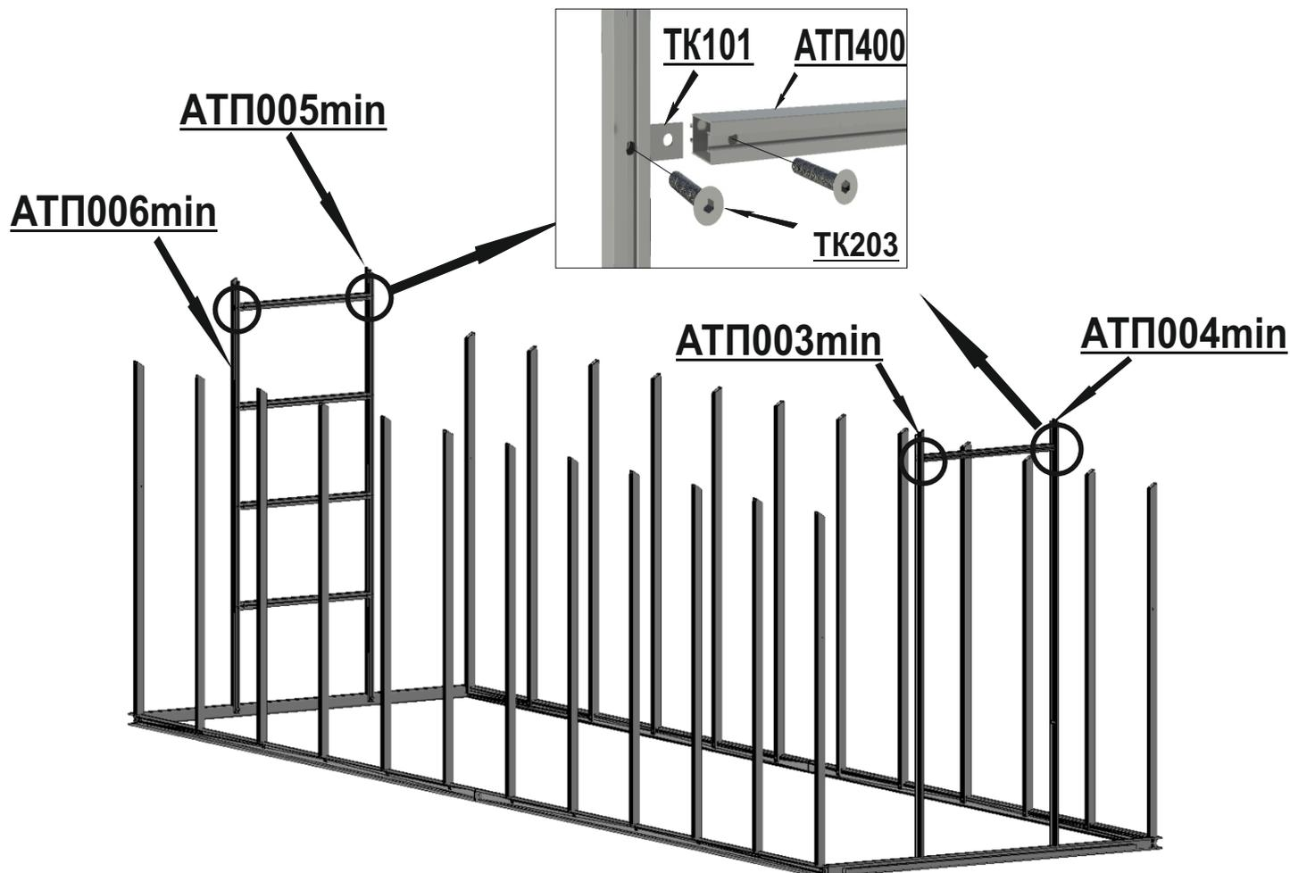
**Шаг 7** Установить на торцевые стойки теплицы АТП003min - АТП006min торцевые крышные шпросы АТП101min и АТП102min, соединить их при помощи элементов ТК100 и винтов ТК203.
