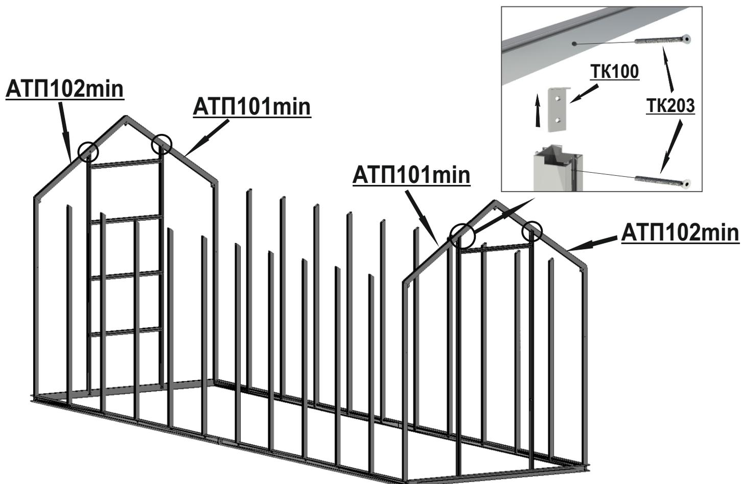
**Шаг 8** Положить боковые коньки АТП255, АТП256 на стойки АТП001, соединив их при помощи планок ТК002, винтов ТК203 и гаек ТК202. Стойку АТП002 и торцевые крышные шпрсы соединить вместе с боковым коньком при помощи «сухаря» ТК001, «специального болта» ТК200 и гаек ТК202.
