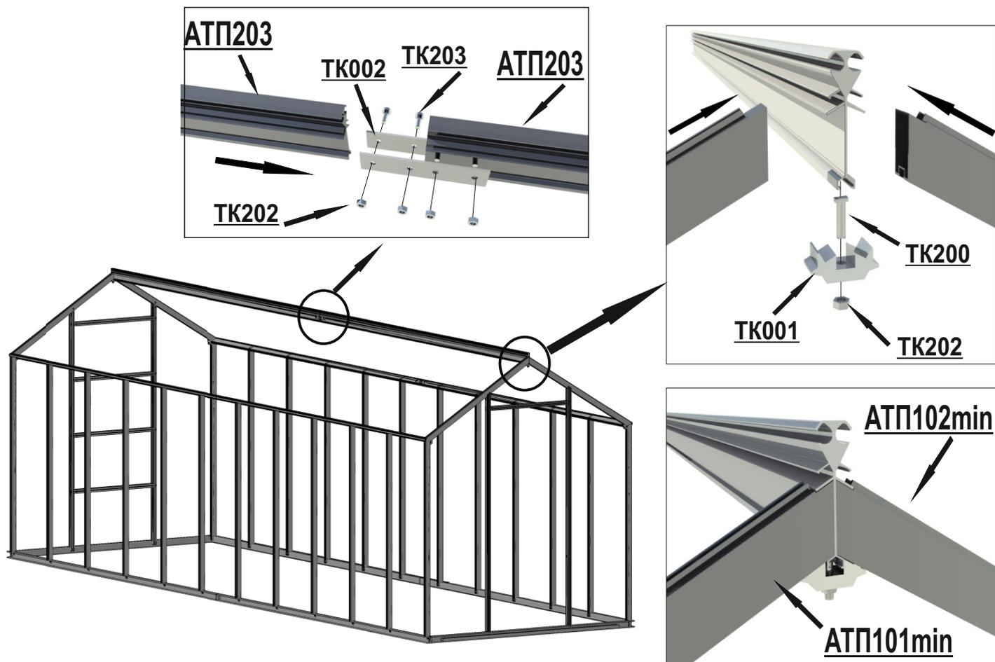
**Шаг 10** Установить, через одинаковое расстояние (590 мм между краями профилей) крышные шпросы **АТП100min**, соединив их с боковым коньком и боковой стойкой **АТП001**, а также между собой и крышным коньком, при помощи «сухаря» **ТК001**, «специального болта» **ТК200** и гаек **ТК202**.
