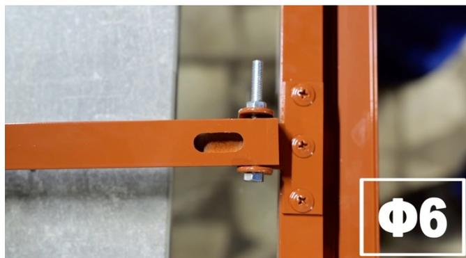
39. Заведите форточку специальным выступом в паз верхнего конька и продвиньте ее до форточного проема. Зкройте форточку полностью (39а – 39г). Установите спецболт в форточную перемычку напротив ручки форточки и закрепите его гайкой (39д, 39е). Установите защитный колпачок на ручку форточки (39и, 39к).
