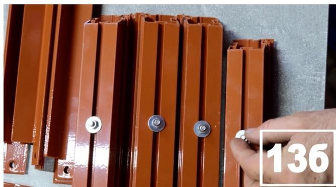
14. Установите болты М6х12 в L-образные пластины, разделив их пополам зеркально (14а, 14б).
