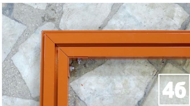
5. Установите шнур резиновый 3.2 мм в пазы всех угловых стоек по одному пазу с каждой стороны (5а, 5б, 5в, 5г).
