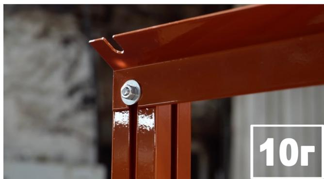
11. Закрепите стоечные уголки на нижние стойки на болты М6х12 (11а, 11б).
