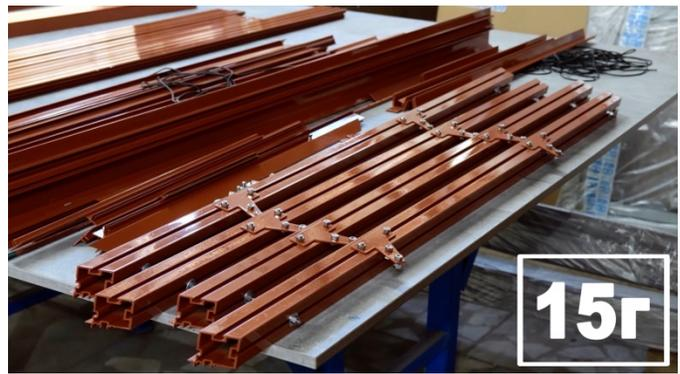
16. Установите болты М6х12 в Т-образные пластины (16а, 16б).
