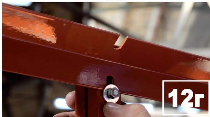
13. Установите болты М6х12 в внутренний паз верхних угловых стоек и временно закрепите их ниже верхнего и нижнего края стойки на 15-20 см гайкой М6 через шайбу (13а, 13б).
