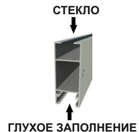
Вставить в двери заполнение в паз профиля и установить верхнюю направляющую **АТП602min**, закрепив ее при помощи винтов **TK203**. По периметру установленного заполнения с двух сторон необходимо установить резиновый уплотнитель **ТРУ004** (
